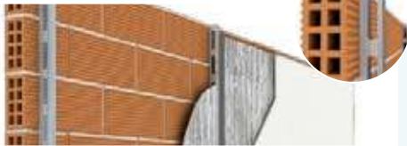
Cerramientos verticales: Aislamiento por interior Trasdosados PYL
